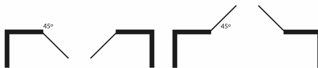
Рисунок 5.35 – Дверной проем с двустворчатыми дверными полотнами
