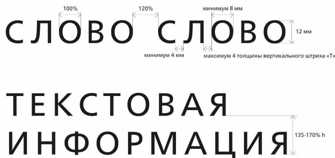
Рисунок 4.4 Параметры шрифтовых знаков и рельефа (рифа) РЛШ
